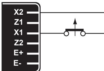
Снятие возбуждения достигается посредством отключения питания регулятора (1 провод - X1 или X2).
