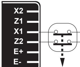
Снятие возбуждения достигается посредством отключения питания регулятора (1 провод на каждой вторичной катушке), номинал контактов 16 A - 250 В переменного тока.
