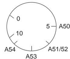
Стабильность изменяется при помощи переключки ST2. По умолчанию она перекрыта. Размыкание данной переключки позволяет в некоторых случаях улучшить показатель времени отклика генератора (за дополнительной информацией обращайтесь к производителю).
