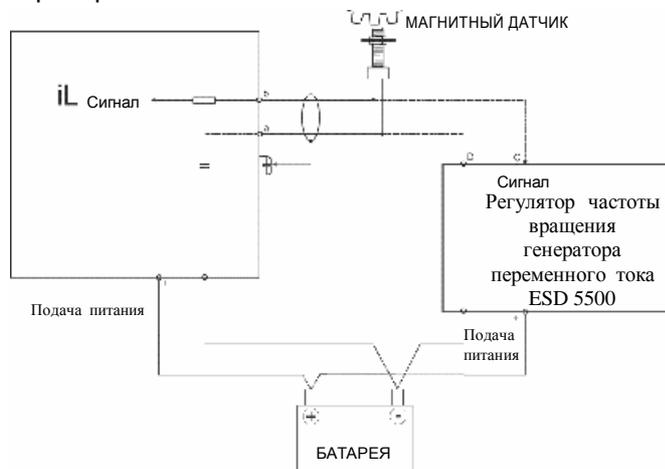
Помните о сигнале помехи от регулятора частоты вращения, когда используется один датчик.
