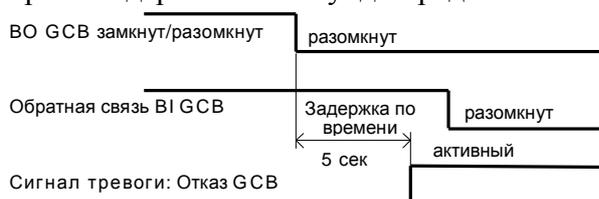
Когда ВО GCB замкнуто/разомкнуто (MCB замкнут/разомкнут) замыкается, существует время задержки в 5 секунд определения неисправности GCB (неисправность MCB).
