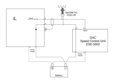
Возможны помехи от электронного регулятора частоты при использовании одного датчика частоты вращения.
