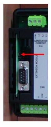
Модуль связи RS 232 с перемычкой Boot Jumper.
