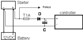
Емкость конденсатора зависит от требуемого времени работы. Приблизительная емкость конденсатора тысяча микрофарад.
